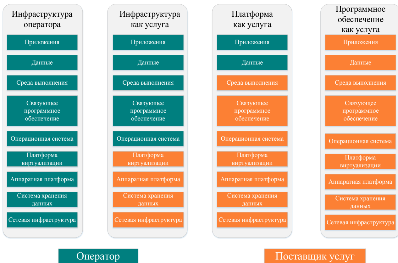
Рисунок 4. Пример распределения границ при оценке угроз безопасности информации в информационной инфраструктуре поставщика услуг
