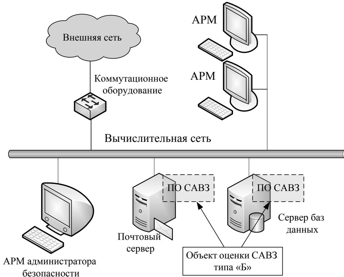
Рисунок 2.1 – Типовая схема ИС, в которой применяется САВЗ типа «Б»
